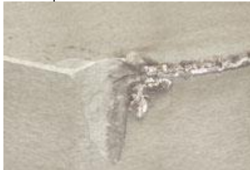
Figura 5 – Desgaste de entalhe em uma ferramenta de corte do tipo HSS.
