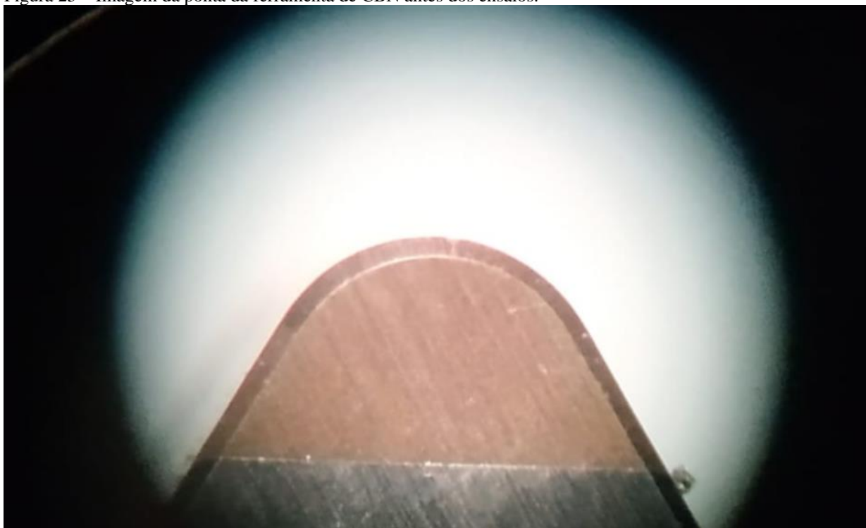
Figura 25 – Imagem da ponta da ferramenta de CBN antes dos ensaios.
