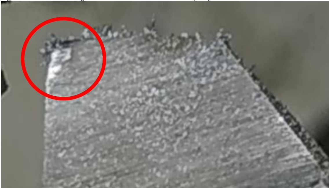
Figura 26 – Primeiros desgastes na aresta de corte do bits de aço rápido
