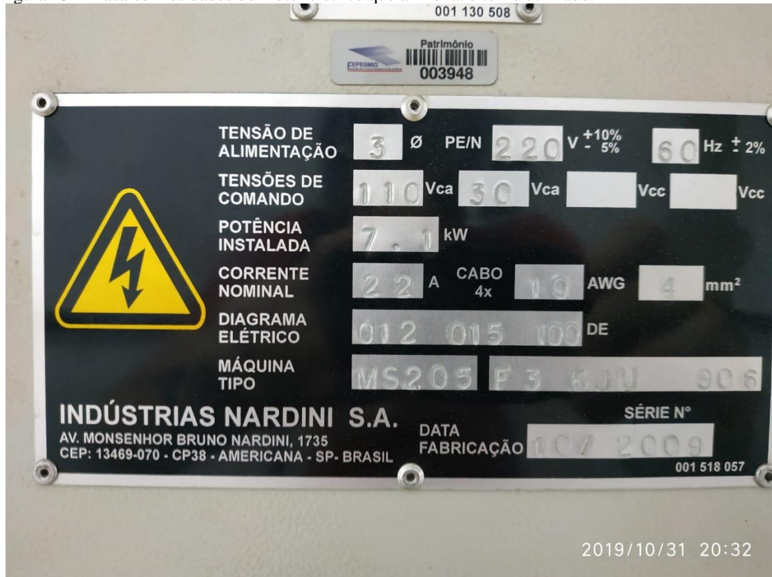
Figura 13 – Placa com os dados do motor elétrico que alimenta o torno utilizado.
