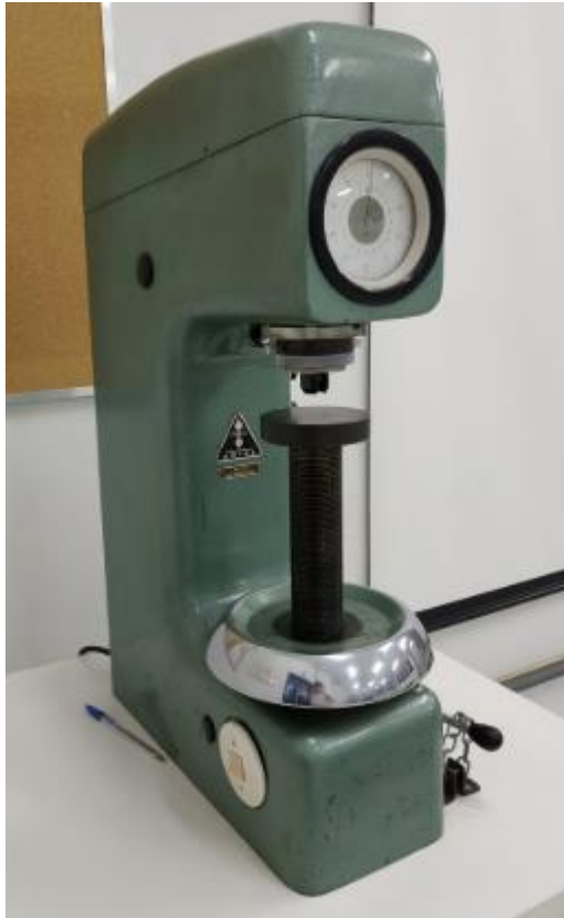
Figura 9 – Durômetro utilizado no ensaio de dureza da amostra do material usinado.
