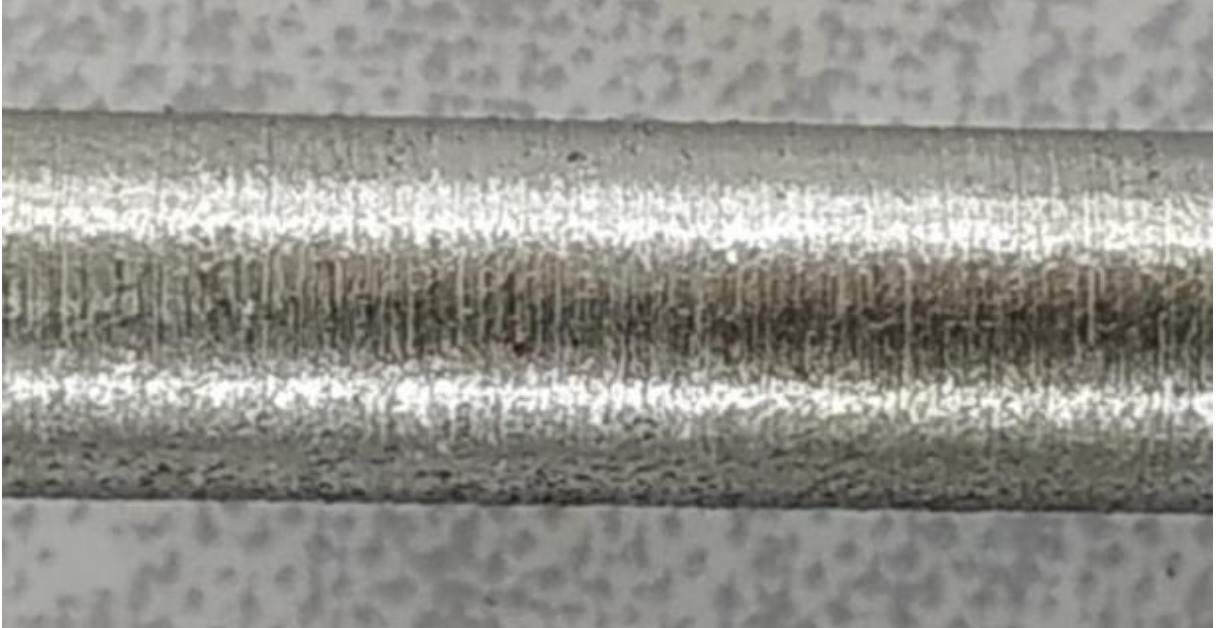
Figura 32 – Superfície da peça usinada pela ferramenta de carboneto de tungstênio ao fim do estudo.
