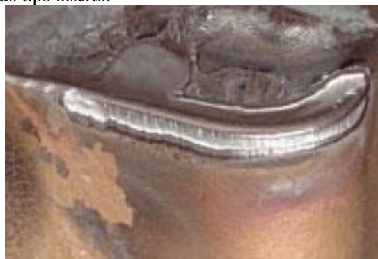
Figura 4 – Desgaste de flanco em uma ferramenta de corte do tipo inserto.
