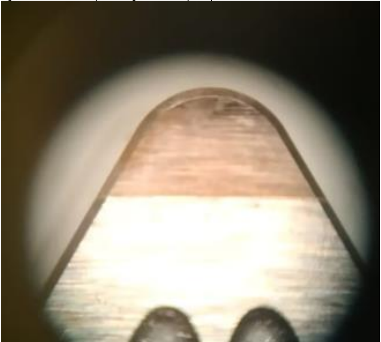
Figura 29 – Ponta de corte após a usinagem dos três corpos de prova.
