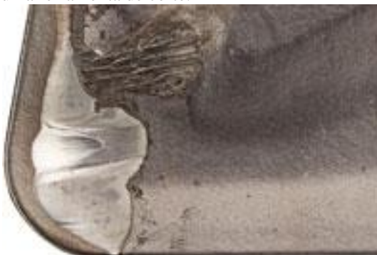
Figura 6 – Desgaste de cratera visto na superfície de ataque de uma ferramenta de corte.
