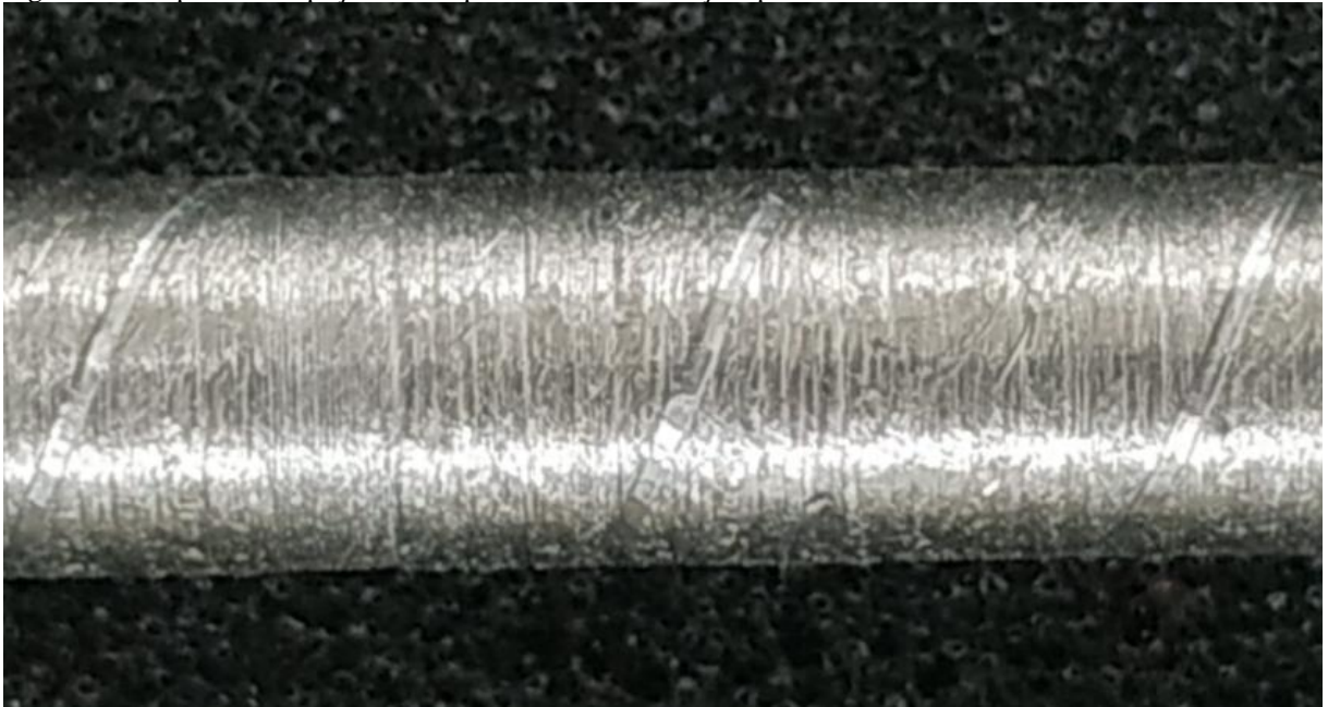
Figura 30 – Superfície da peça usinada pela ferramenta de aço rápido ao fim do estudo.
