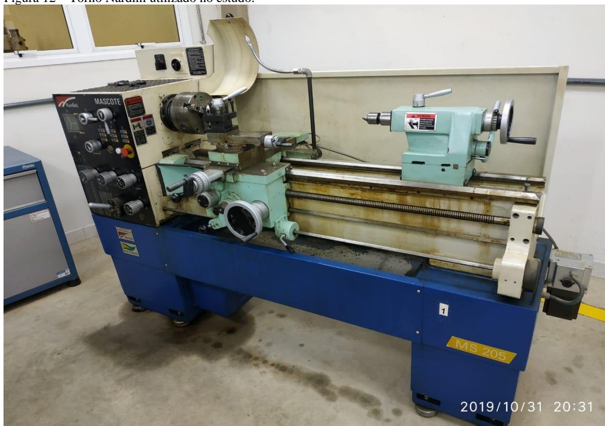
Figura 12 – Torno Nardini utilizado no estudo.
