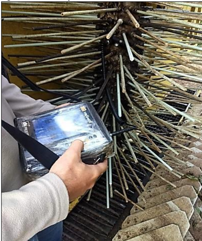
Figura 11 - Coleta da Frequência Natural na árvore da colhedora.
