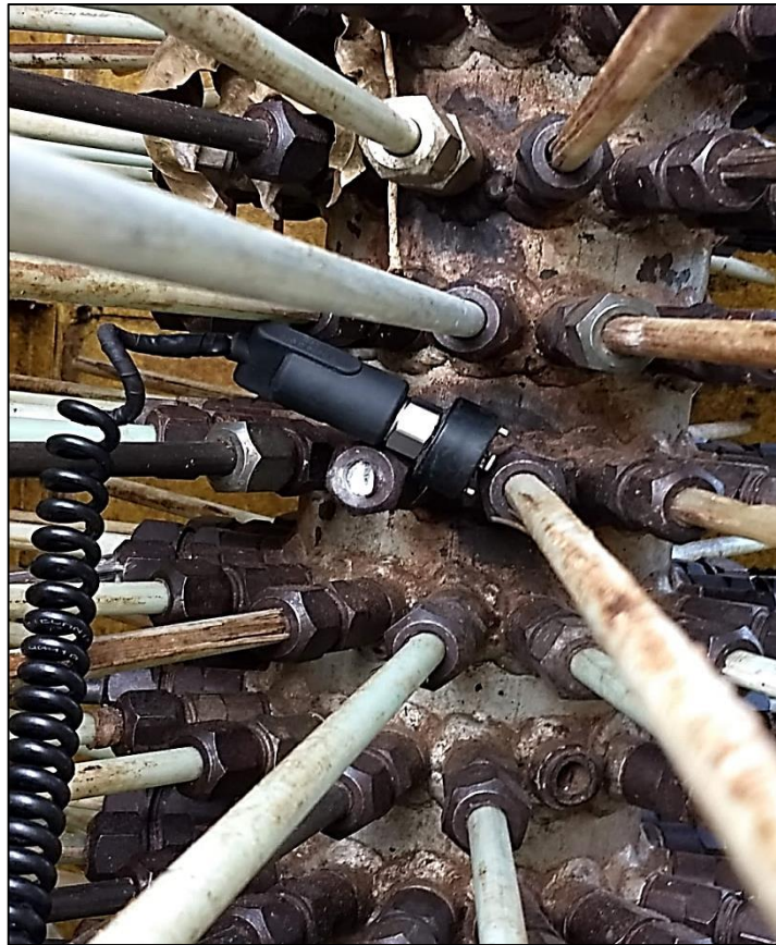
Figura 12 - Coleta da Frequência natural nas varetas da colhedora.
