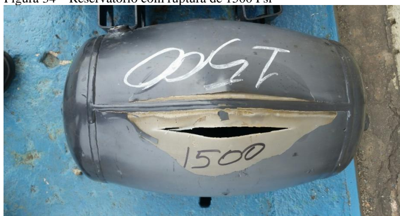
Figura 34 – Reservatório com ruptura de 1500 Psi
