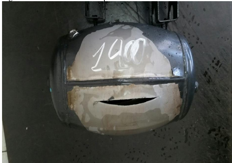
Figura 36 – Reservatório com ruptura de 1400 Psi
