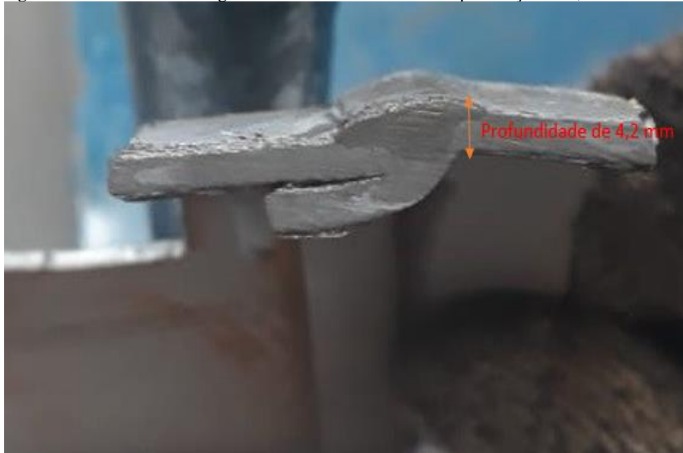
Figura 39 – Ensaio de macrografia na solda MIG/MAG com penetração de 4,2mm
