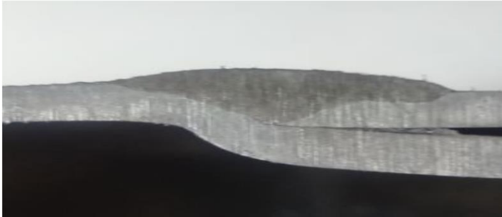
Figura 37 – Ensaio macrográfico na solda MIG/MAG
