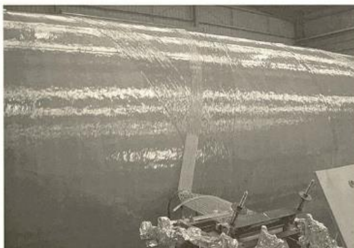
Figura 09 - Processo por laminação helicoidal sendo executado.
