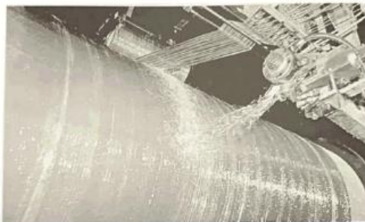
Figura 10 - Fibras picadas e a resina sendo aplicadas com pistola.
