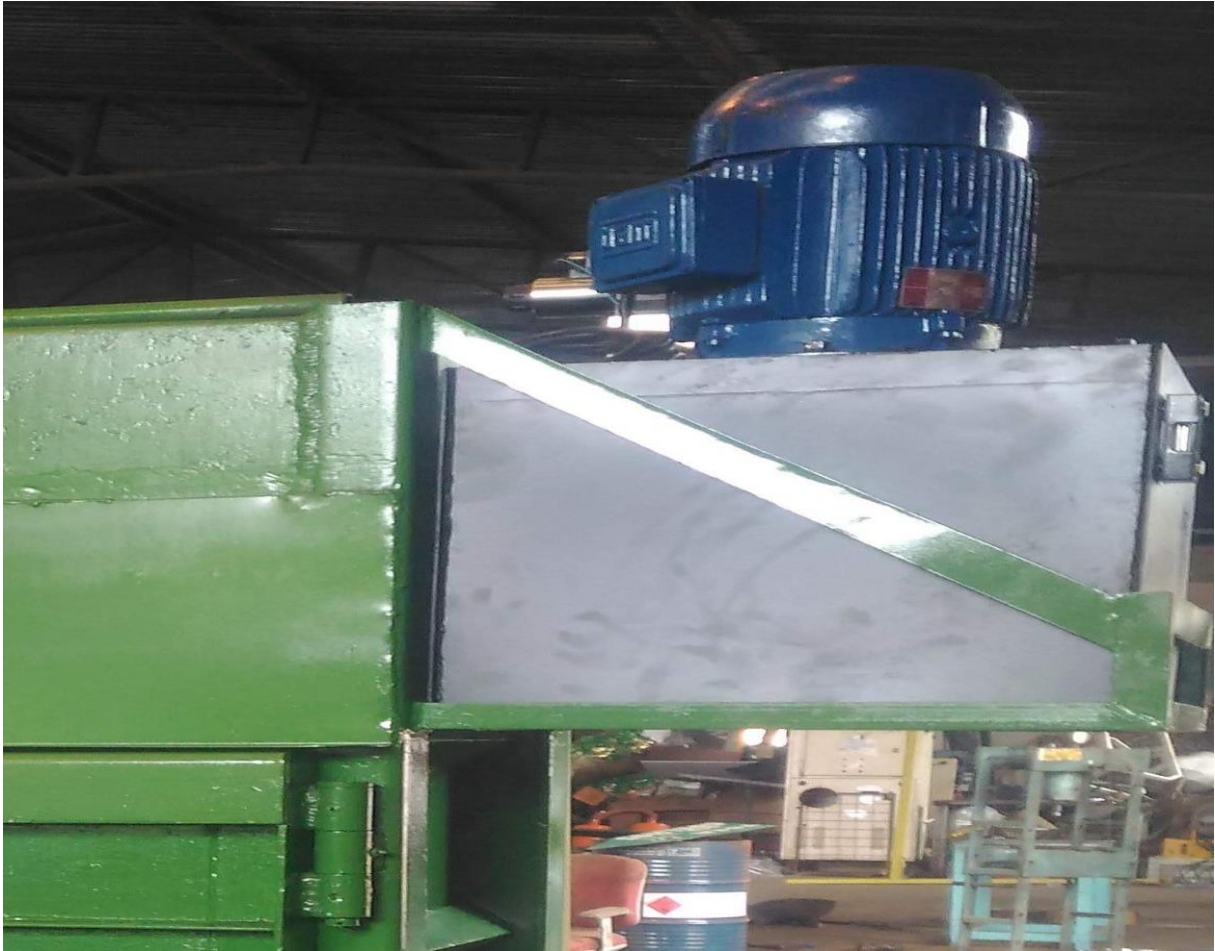
Figura 7 - Reservatório hidráulico funcionando como proteção fixa.
