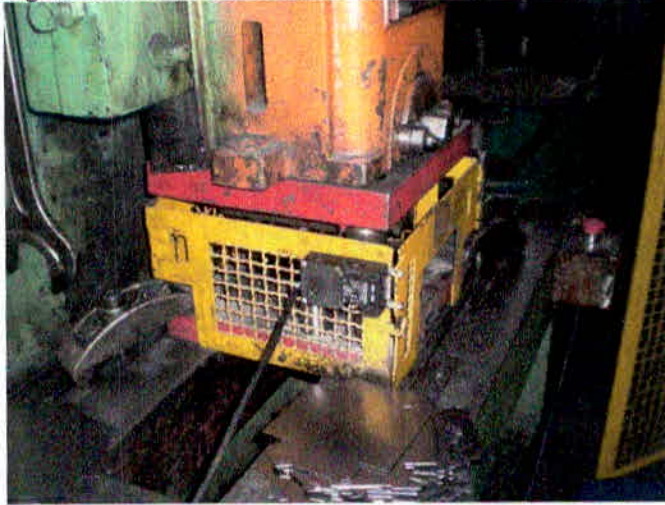
Figura 20- Ferramenta fechada dotada de chave de segurança
