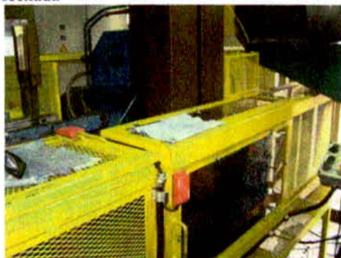
Figura 06 - Proteção móvel intertravada fechada
