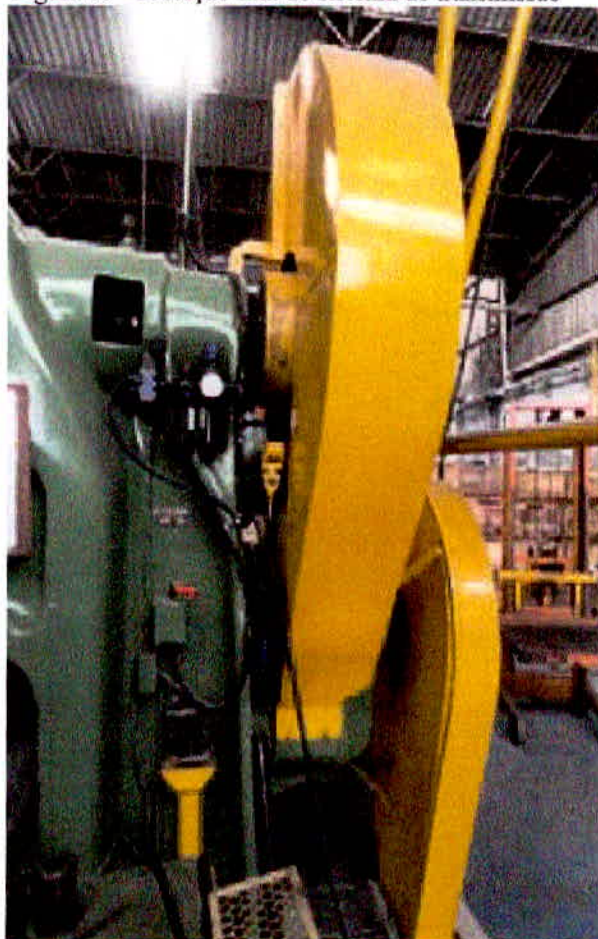
Figura 05 - Proteção fixa do sistema de transmissão
