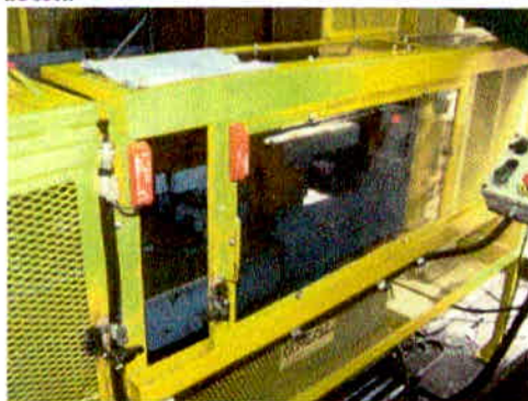
Figura 07: Proteção móvel intertravada aberta
