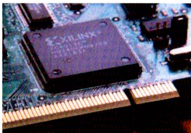
Figura 07: Exemplo de componente SMD
