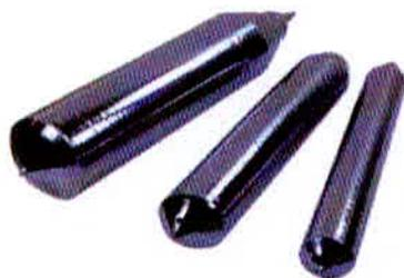
Figura 6 - Cilindros de silício.
