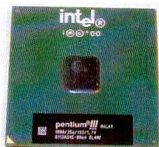
Figura 31 - Encapsulamento FC-PGA.
