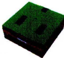
Figura 26 - Wafer após remoção do material fotossensível da terceira camada. Fonte: MORIMOTO, 2010.
