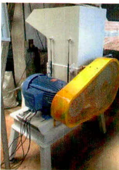
Figura 14: Moinho granulador rotativo com facas fixas
