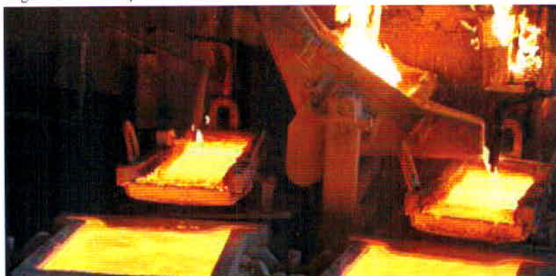
Figura 03 - Fundição do anodo
