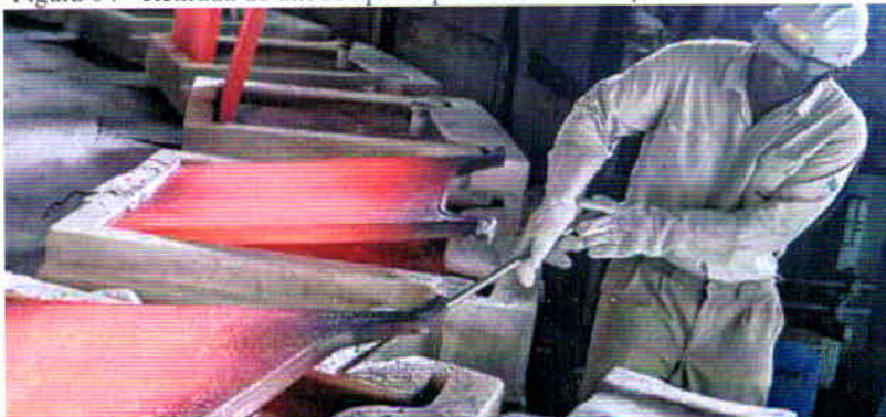
Figura 04 - Retirada do anodo após o processo de fundição
