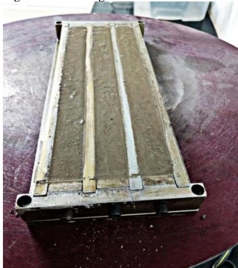
Figura 21 - Moldagem das barras
