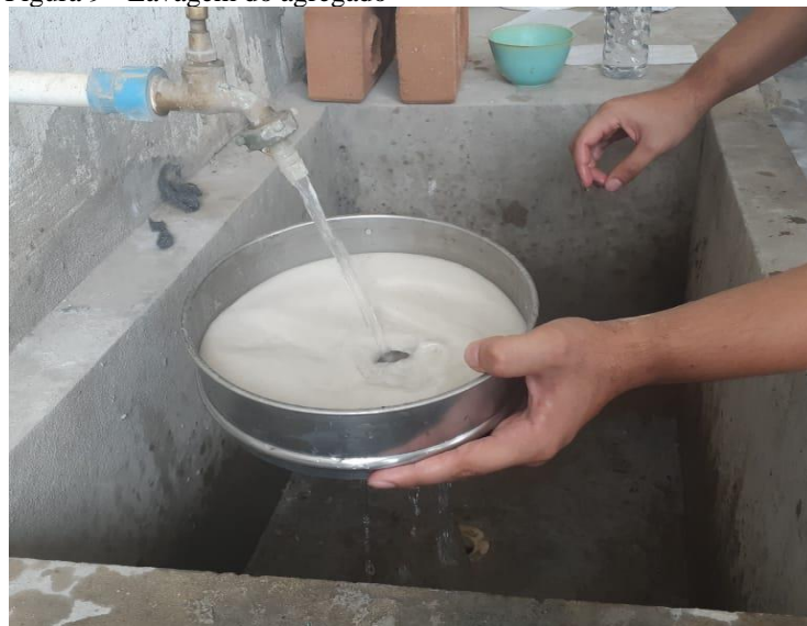
Figura 9 - Lavagem do agregado
