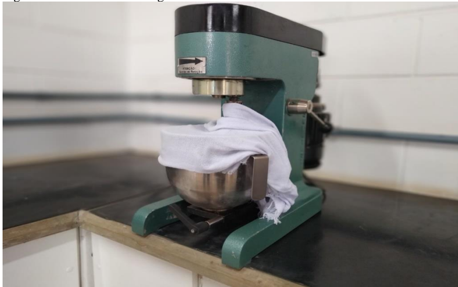
Figura 20 - Misturador da argamassa
