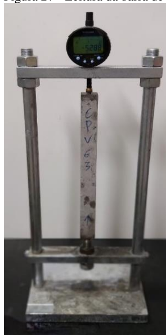
Figura 27 - Leitura da barra de argamassa
