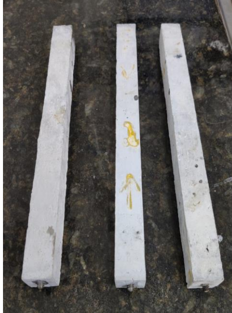
Figura 24 - Barras desenformadas do Traço 3
