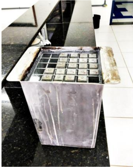
Figura 25 - Recipiente com as barras de argamassa
