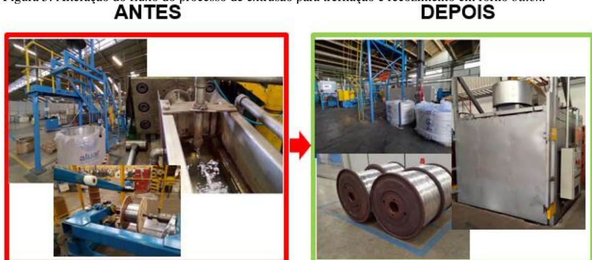
Figura 5: Alteração do fluxo do processo de extrusão para trefilação e recozimento em forno batch .
