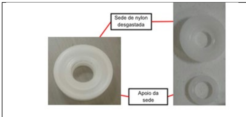
Figura 5 - Sede de nylon desgastada
