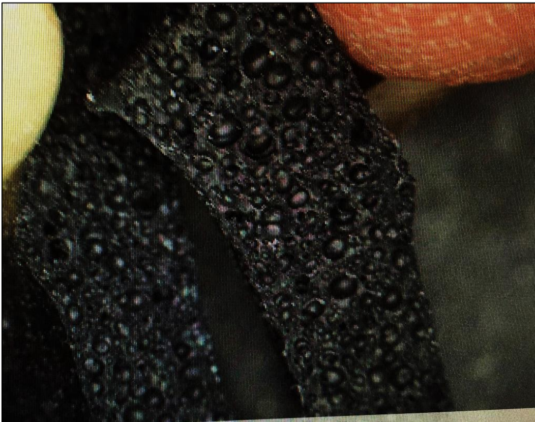
Figura 6 – Presença de material pré vulcanizado no perfil 2.
