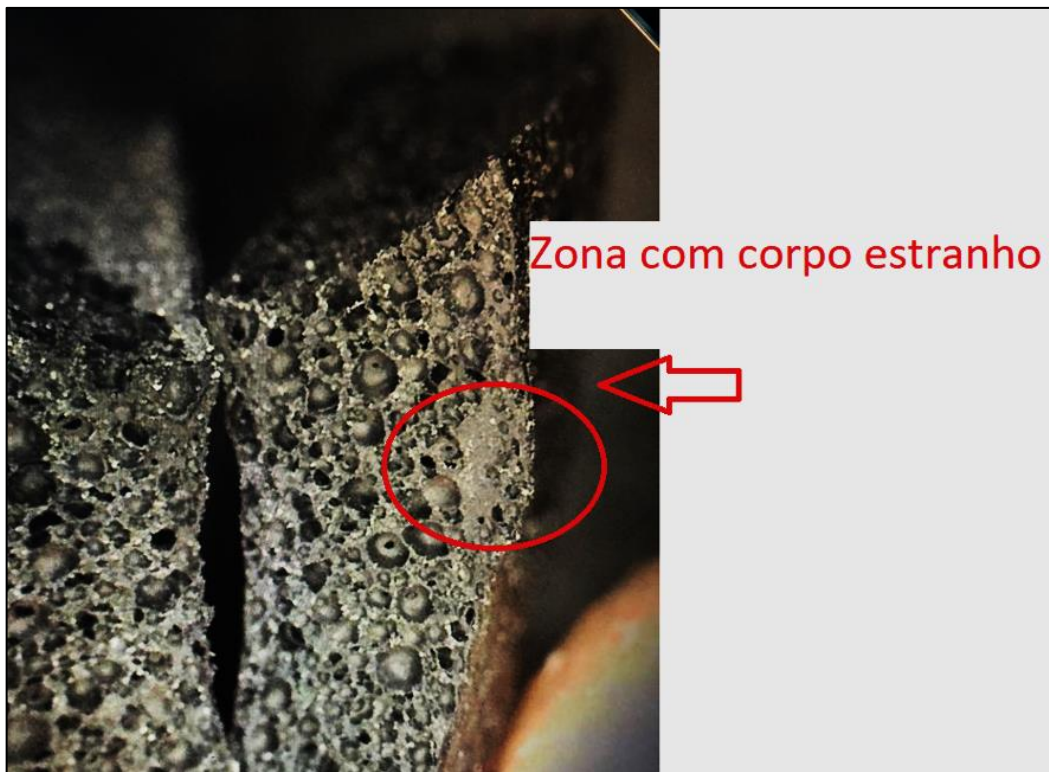
Figura 5 – Presença de material pré vulcanizado no perfil.
