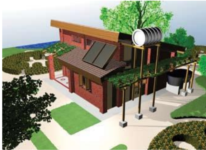
Figura 4 - Disposição das placas e reservatório do coletor solar
