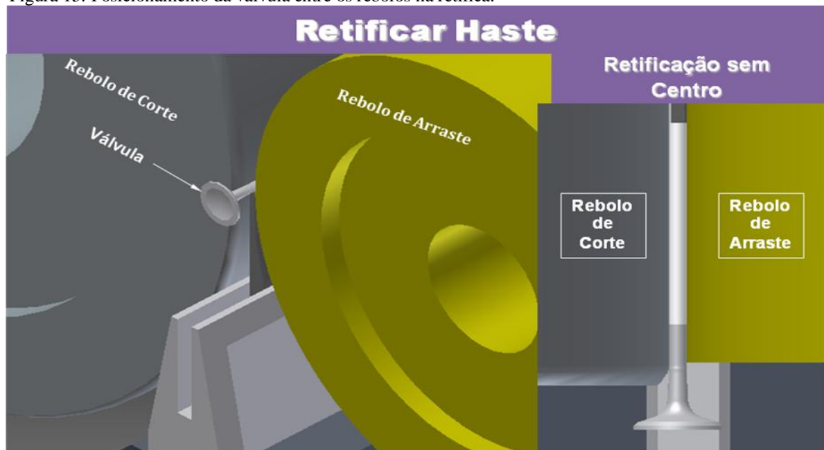
Figura 15: Posicionamento da válvula entre os rebolos na retífica.
