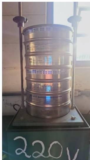
Figura 9 - Aparelho vibratório usado para ensaio de granulometria.
