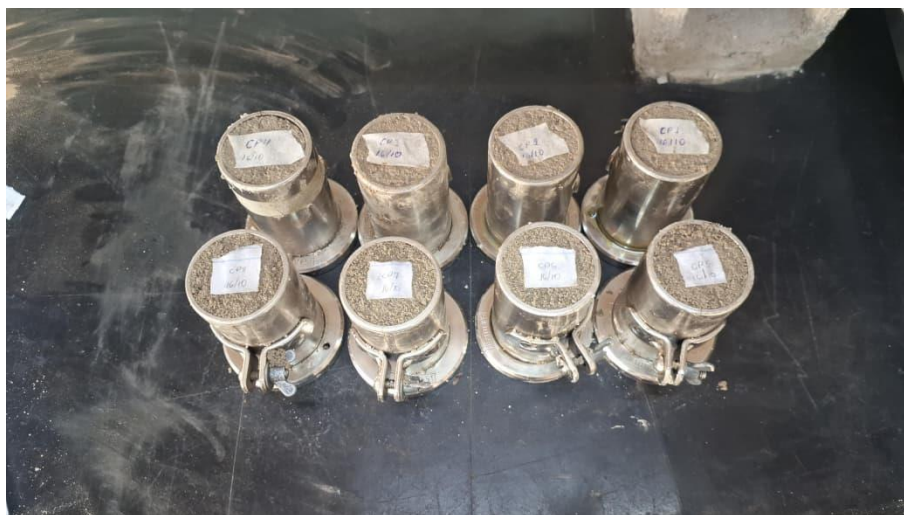
Figura 19 - Corpos de prova para atividades pozolânicas.
