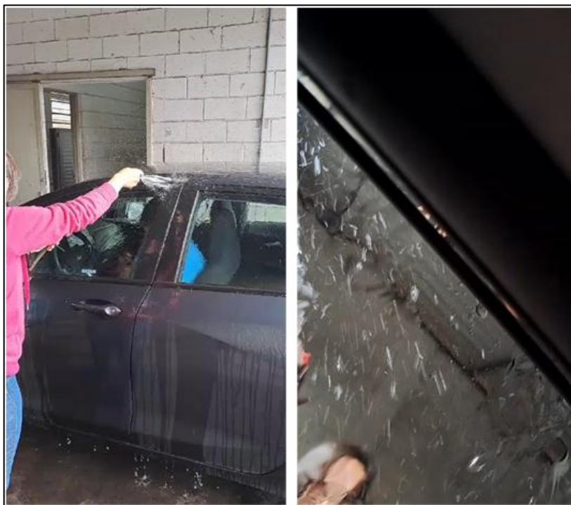
Figura 20: Peça com inserto modificado no veículo em teste de estanqueidade.
