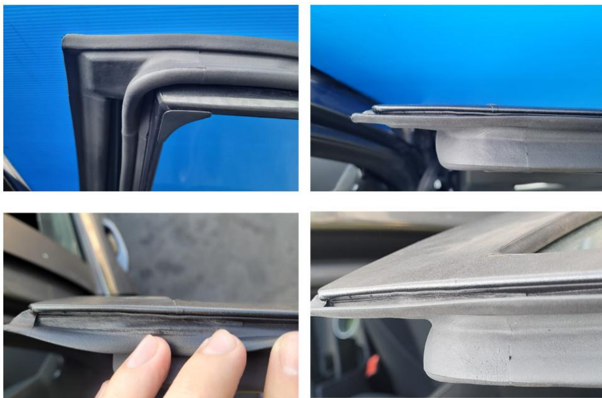
Figura 19: Peça modificada sem extensão do inserto.
