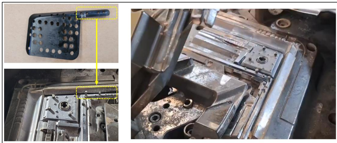
Figura 8: Posicionamento manual do inserto no molde.
