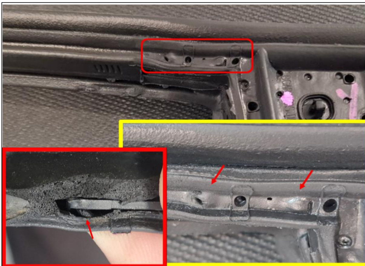
Figura 14: Peça com deformação na extensão do inserto após moldagem.
