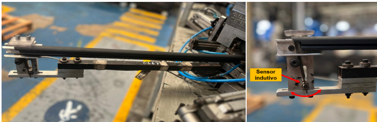
Figura 30: DETECÇÃO - Elaboração e instalação de poka yoke
