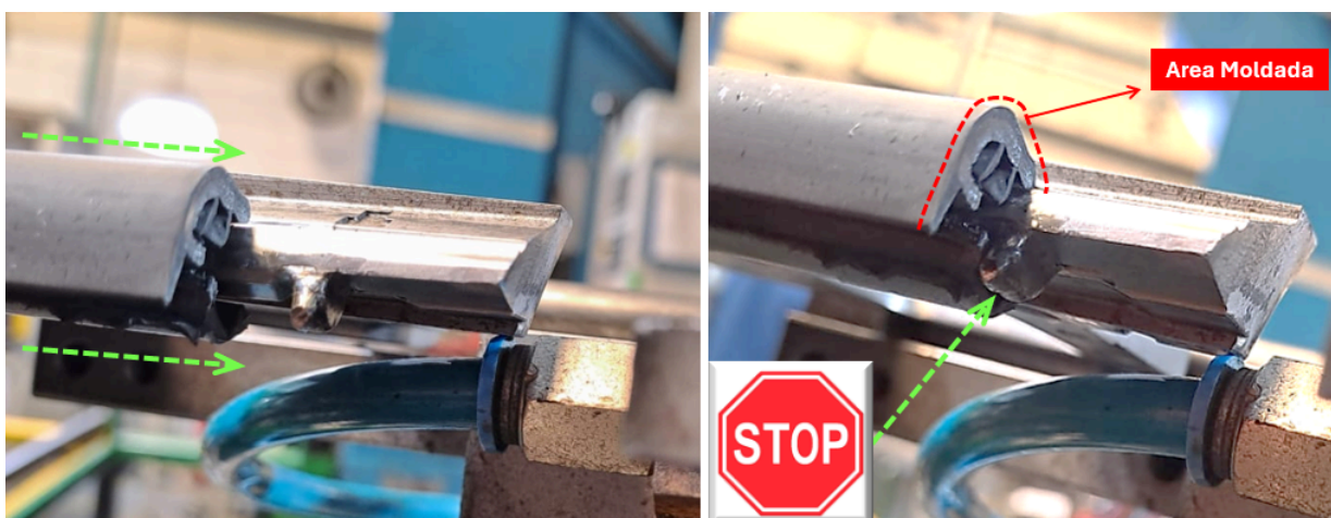
Figura 31: OCORRENCIA - Confeção de stop fixo na placa do molde
