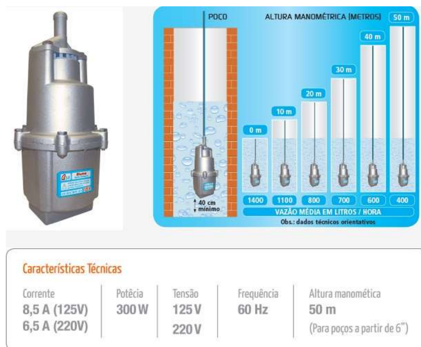
Figura 6: Especificações da bomba Bluma 5.0.
