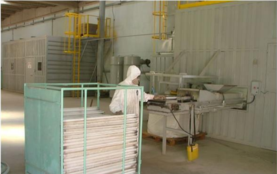
Figura 15 – Separação dos constituintes das lâmpadas 2
