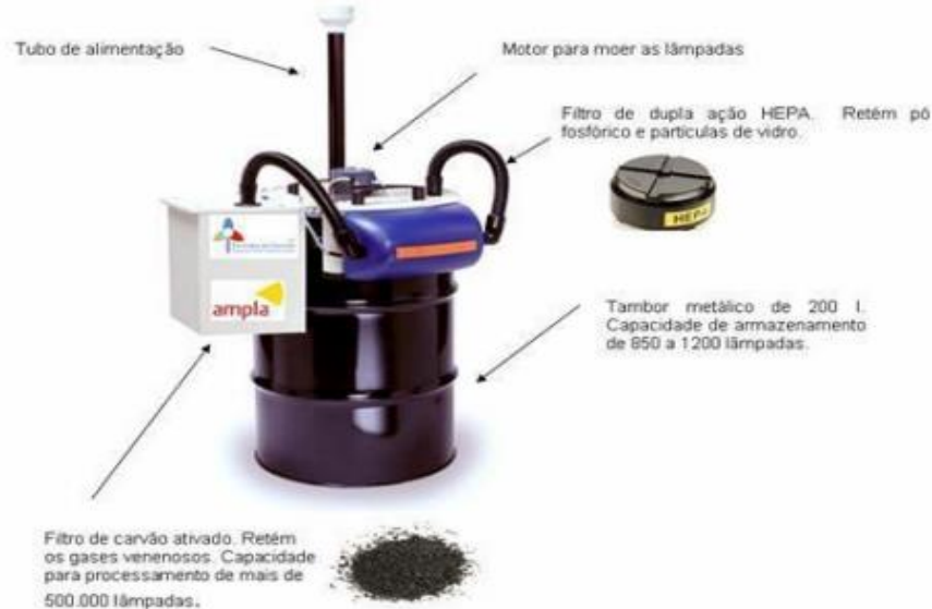
Figura 11 – Ilustração do equipamento de descontaminação “Papa – lâmpadas”
