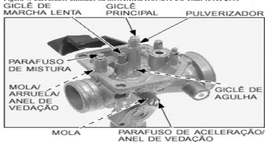
Figura 4: Carburador utilizado na motocicleta HONDA CG Titan 150cc 2008
