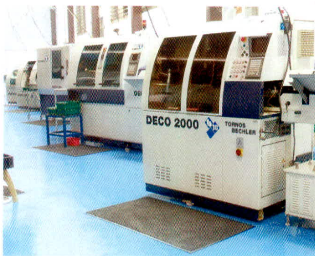
Figura 3 – Torno automático CNC, monofuso, fixado por pinça, Cabeçote móvel, com alimentador de barras e fuso horizontal Fonte: Tormep
