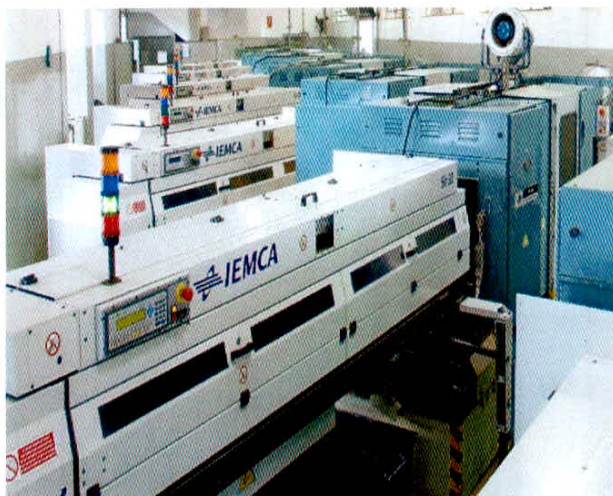
Figura 2 – Torno automático multifuso com alimentador de Barras e cabeçote fixo, fuso horizontal acionado por cames Fixado por pinças Fonte: Tormep
