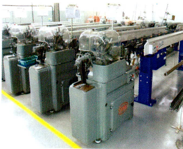
Figura 1 – Torno Automático monofuso com alimentador de Barras e cabeçote móvel, fuso horizontal acionado por cames Fixado por pinças Fonte: Tormep
