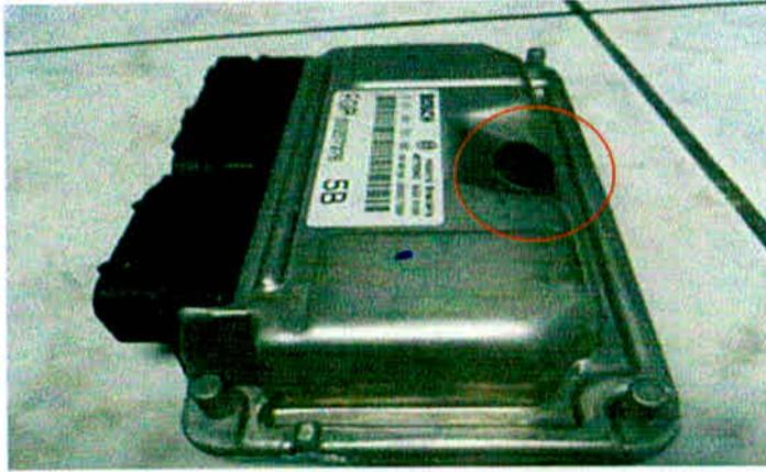
Figura 18- Detalhe do sensor barométrico em um módulo de comando
