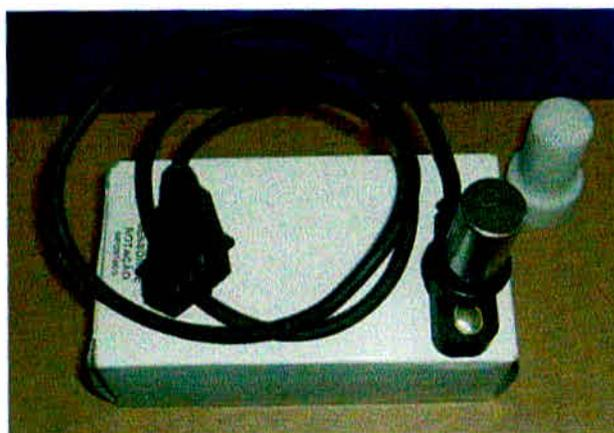
Figura 12- Sensor de rotação
