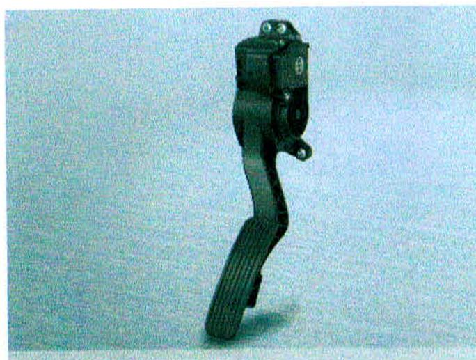
Figura 17- sensor do pedal do acelerador acoplado ao pedal
