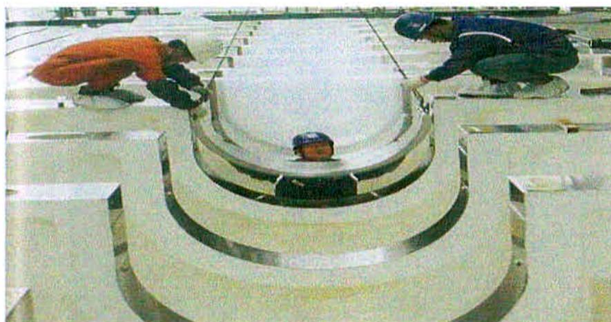
Figura 27- Montagem das bronzinas nos mancais fixos do bloco do motor RTA 96-C
