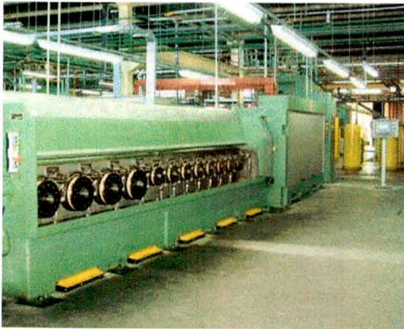
Foto16: Máquina de trefilação primária
