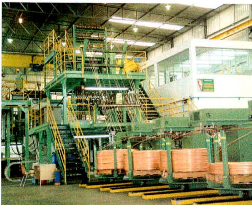
Foto13: Máquina de fundição contínua onde é retirado o cobre OF.
