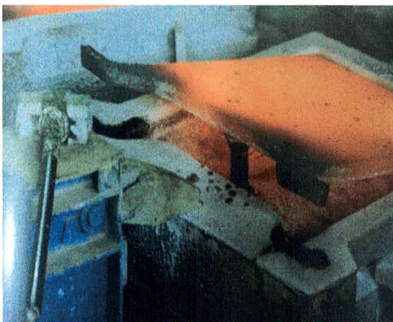
Foto 06: Retirada de *anodos* do molde, após a fundição na roda de moldagem
