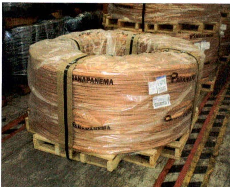
Foto09: Jumbo de cobre produzido pelo processo ETP
