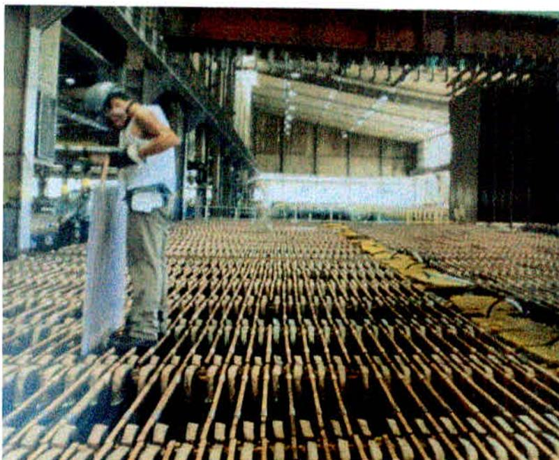
Foto07: Trabalho de inspeção de curtos nas células eletrolíticas
