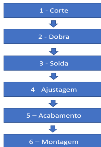
Figura 3 - A linha de produção de cilindros conta com os seguintes processos
