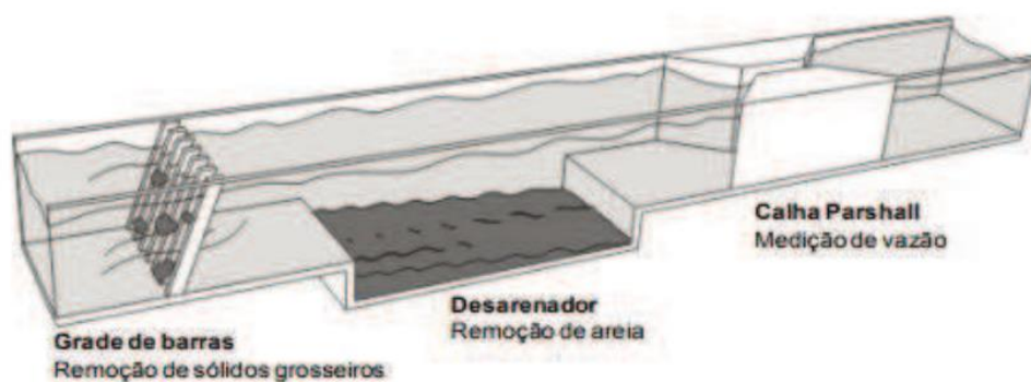
Figura 11 – Fluxograma típico do tratamento preliminar
