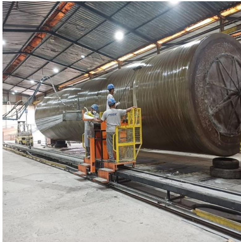
Figura 5. Laminação Filament Winding
