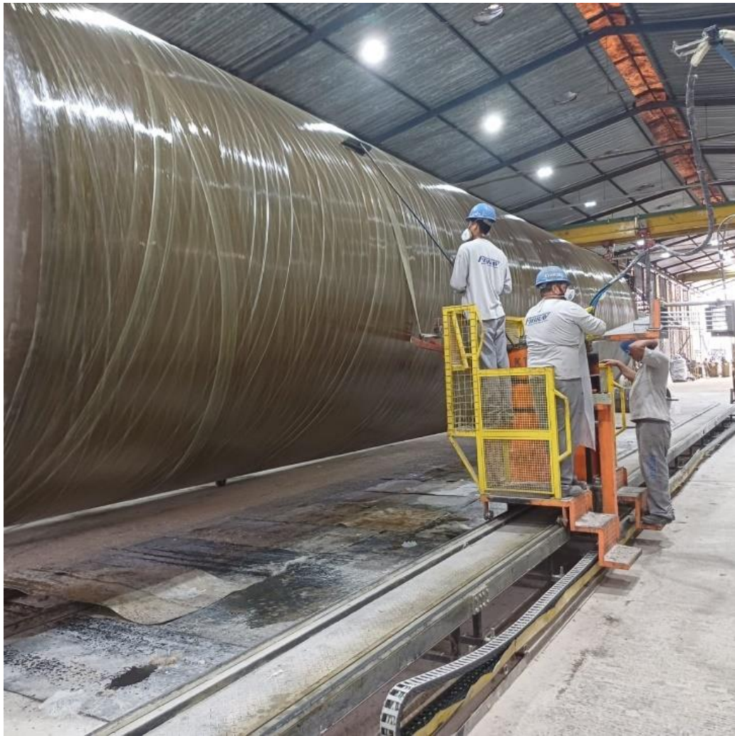
Figura 20. Direção preferencial dos em fibra de vidro
