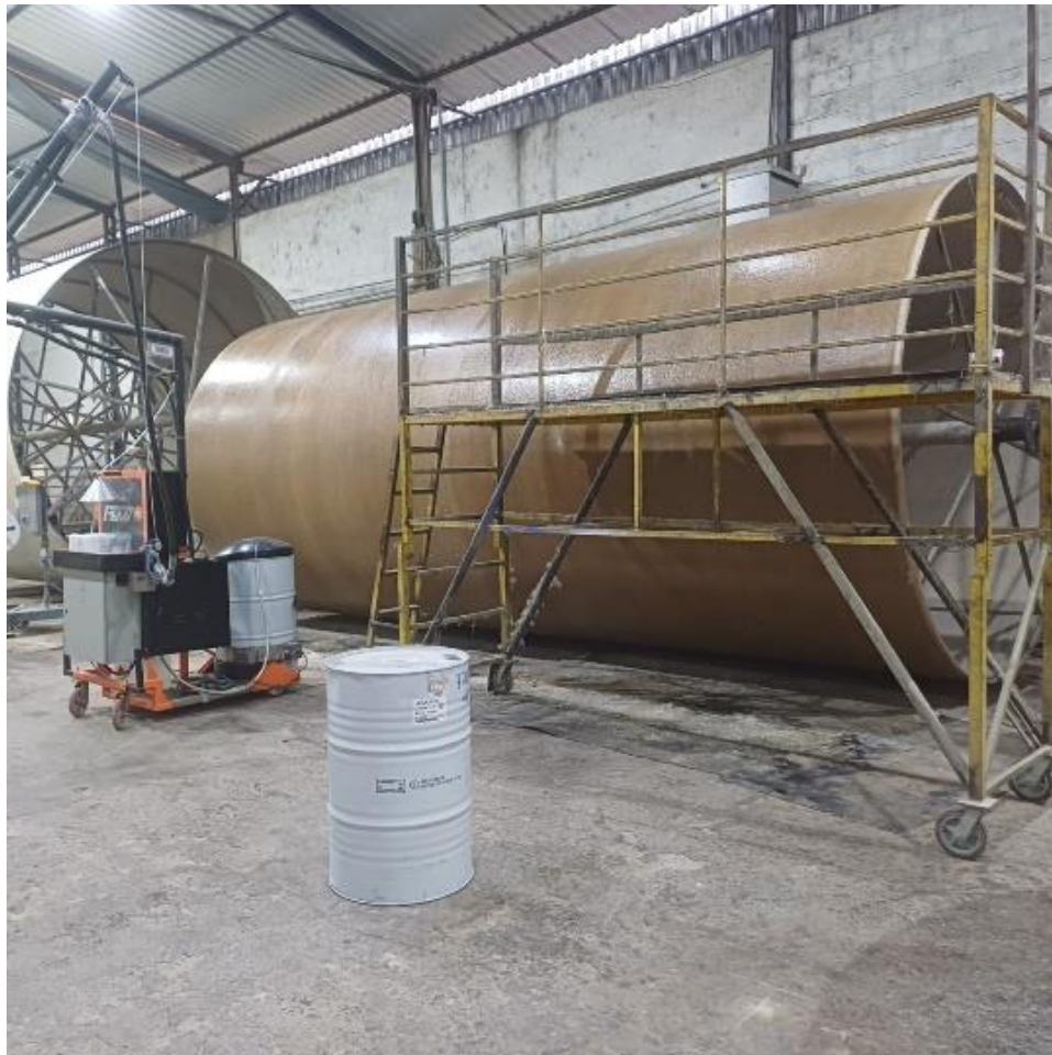
Figura 26. Fabricação do costado pelo método Spray-up
