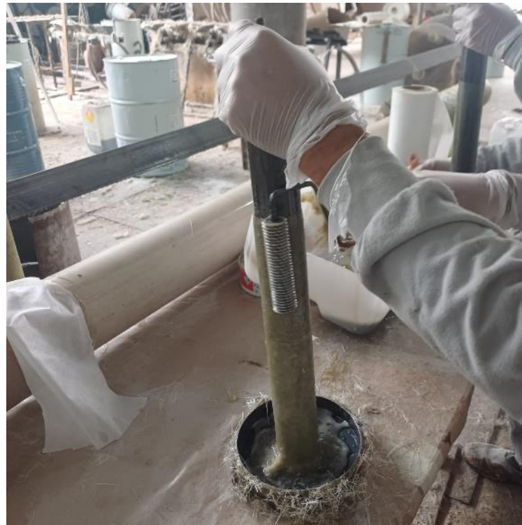
Figura 3. Laminação Hand lay-up
