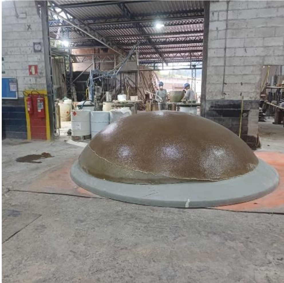
Figura 27. Fabricação do tampo superior Spray-up
