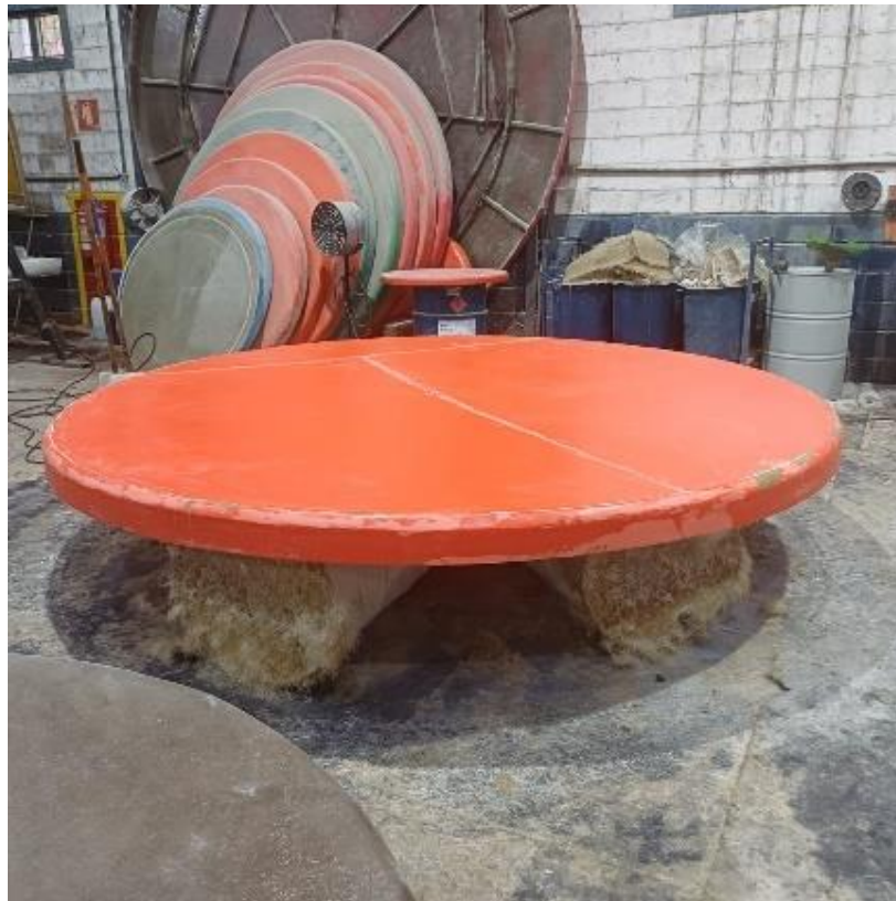
Figura 25. Fabricação do tampo inferior pelo método Spray-up
